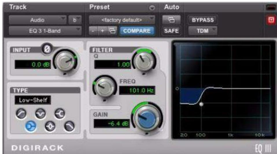
Figure 98 Ici, on a un filtre Low-Shelf, avec une valeur de Q de 1.00, la fréquence est réglée sur 101.0 Hz, et l'atténuation des fréquences inférieures est de -6.4 dB.
