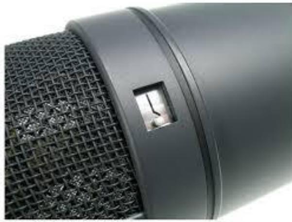
*Figure 80 Le switch coupe-bas enclenché sur le micro*
