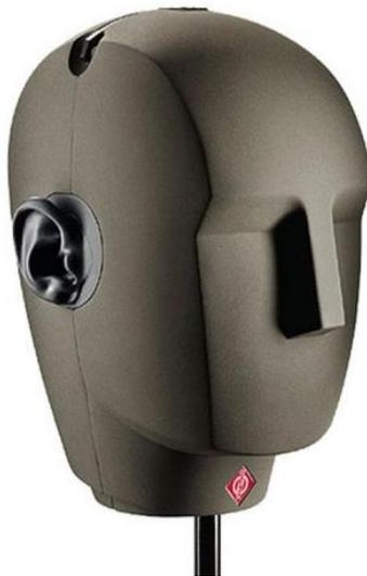
Figure 29 La tête artificielle KU 101 de Neumann
